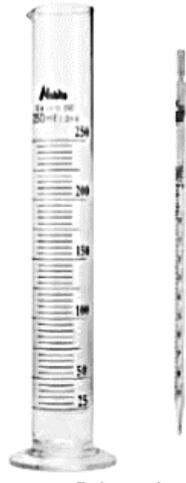
▲ Probeta y pipeta
